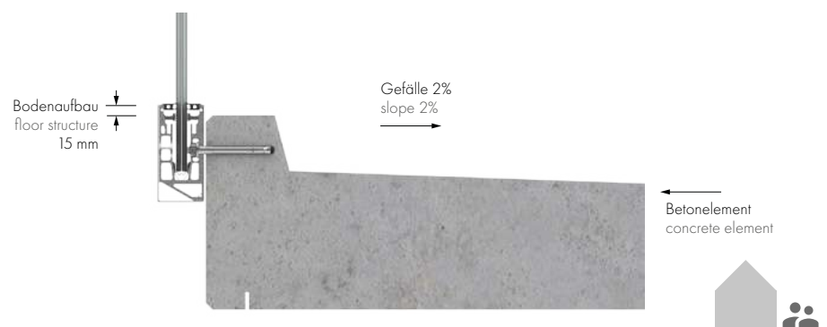
(B) Außenanwendung: Beispiel Balkon mit Betonelementen, Gefälle nach innen exterior application: example balcony with concrete elements, slope inwards
