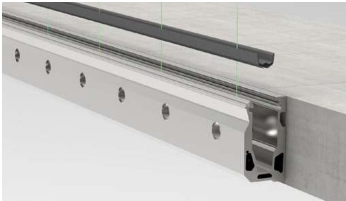
2. Unteres Verglasungsprofil einsetzen (im Außenbereich an den Entwässerungsbohrungen aussparen/Entwässerungsbohrungen bauseits) insert lower glazing profile (for outdoor usage, blank out at the drain holes. drainage holes drilled on site)
