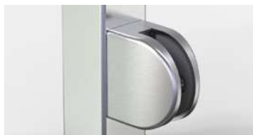
Modell 55 x 60 mm Glasdicke | glass thickness: 8 – 12,76 mm Seite | page 223
