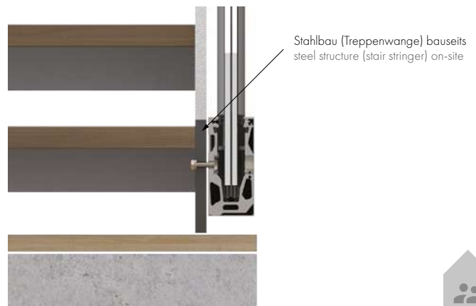
(E) Innenanwendung: Beispiel Treppe mit Flachstahlwange interior application: example staircase with flat steel stringer
