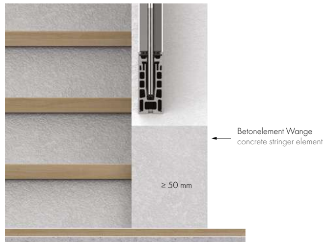
(E) Innenanwendung: Beispiel Treppe mit Betonelement Wange interior application: example staircase with concrete stringer element
