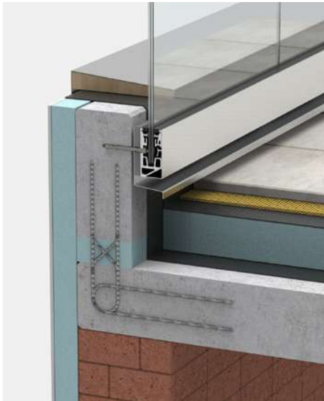
(C) Außenanwendung: Beispiel Balkon-Attika, gedämmt, Profil innen exterior application: example balcony attika, insulated, profile inside
