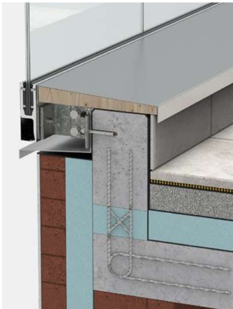
(C) Außenanwendung: Beispiel Balkon-Attika mit Betonelementen gedämmt exterior application: example balcony attica insulated with concrete elements
