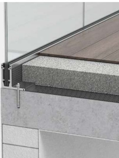
(E) Innenanwendung: Beispiel Empore/Laubengang mit eingelassenem Profil interior application: example porch / portico with recessed profile
