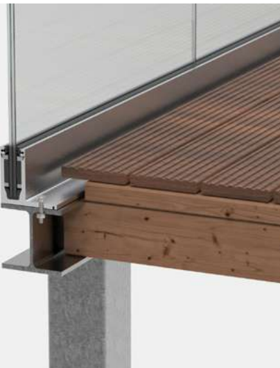
(D) Außenanwendung: Beispiel vorgesetzter Anbaubalkon exterior application: example front extension balcony
